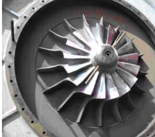
تركيب محرك جديد في ضاغط غاز المرحلة الأولى من المعالجة في مصنع الاختزال المباشر-٢ (أبريل ٢٠٠٩)
